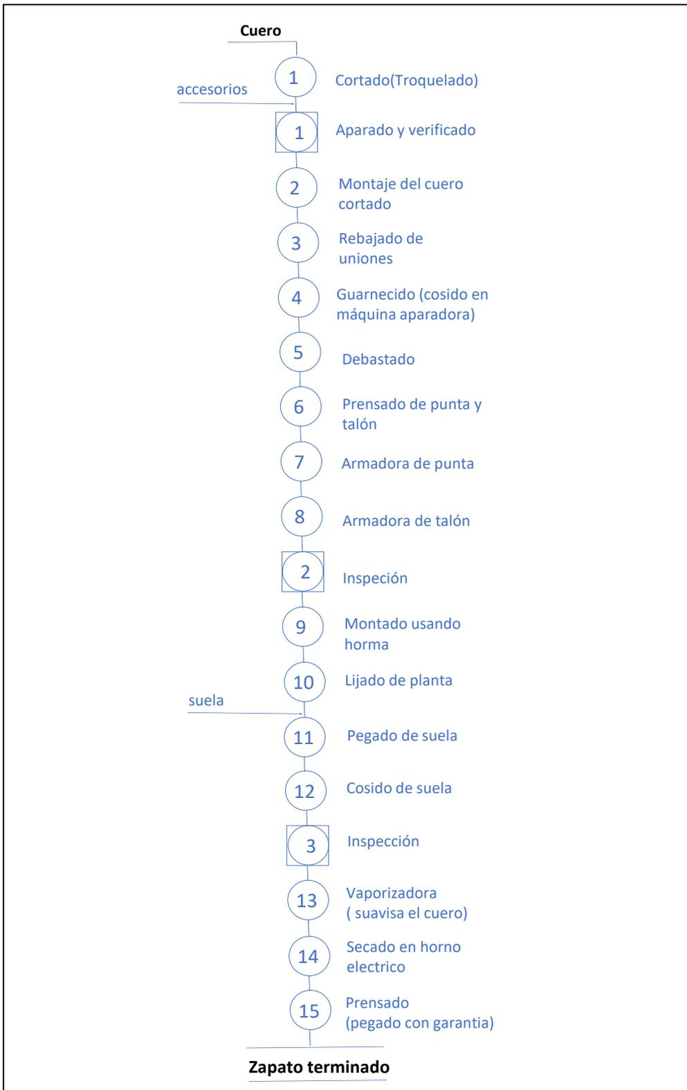
**Figura 4.** Diagrama DOP de la fabricación de un zapato de colegio.
