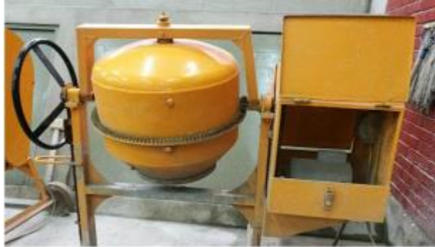
Fig.5 Mezcladora de concreto (fuente propia)
