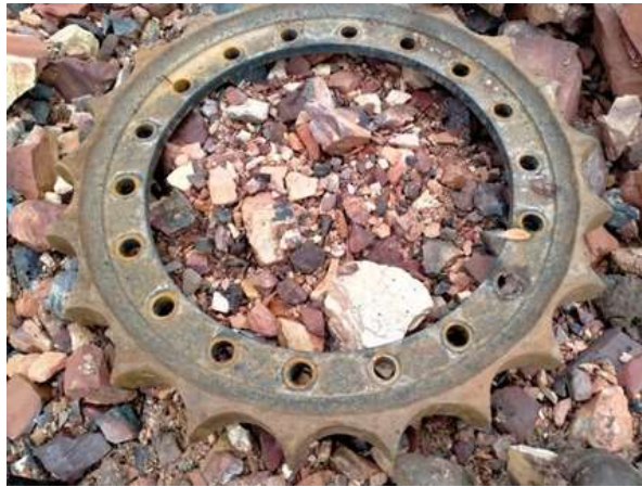
Gambar 9. Sprocket Yang Mengalami Kerusakan
