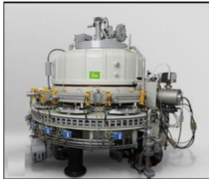
La aceleración de electrones tiene lugar en una cámara de vacío al recorrer una trayectoria de varios bucles conformando la proyección de una margarita (Rhodos, del griego flor) atravesando varias veces el centro de la cámara, lo que permite el funcionamiento del equipo en modo continuo (**Figura 13**).
