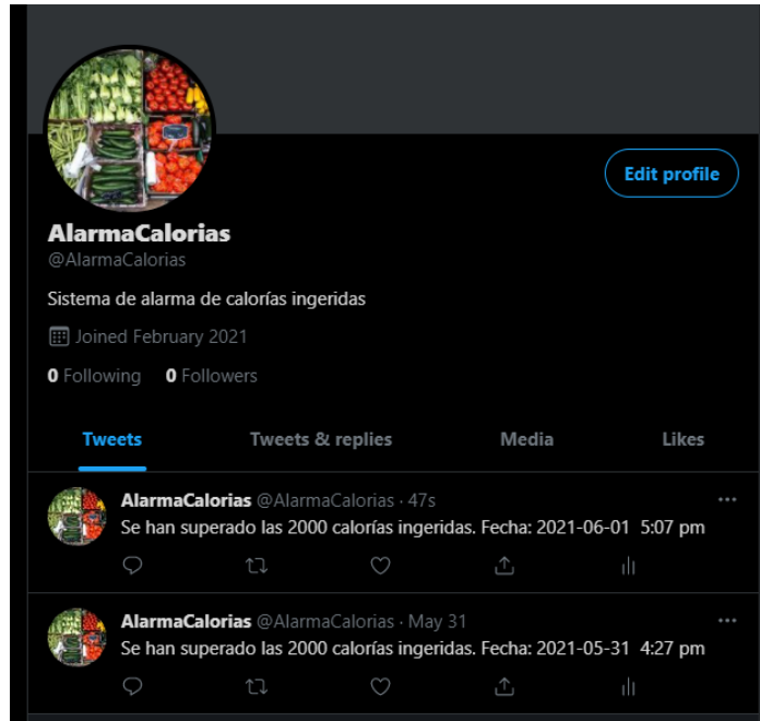
Figura 4.17. Perfil de la cuenta @AlarmaCalorias con los mensajes de alarma generados por ThingTweet
