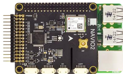
Fig 5. Placa Navio2 montada sobre Raspberry (11).
