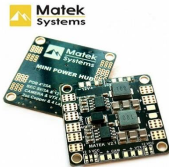
Fig 3. Power distribution board de la marca Matek (9).
