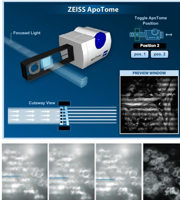
**Figura 50. Microscopía óptica con ApoTome (Zeiss).** Arriba: Proyección de la rejilla de ApoTome sobre la muestra en diferentes posiciones espaciales diferentes en el plano de enfoque. Abajo: Ilustración esquemática de la proyección de la rejilla y resultado final de la muestra. Modificadas de <https://www.zeiss.com/microscopy/us/products/imaging-systems/apotome-2-for-biology.html>
