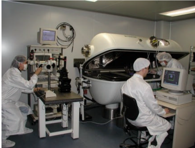
Figura 9. Ensayos ópticos de la rueda de filtros del instrumento Osiris en la cámara de vacío del LINES (INTA) para la simulación de las condiciones ambientales espaciales.
