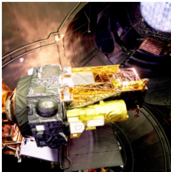
Figura 11. En la fotografía de la izquierda se muestra el satélite Integral de la ESA durante los ensayos en cámaras ambientales.
