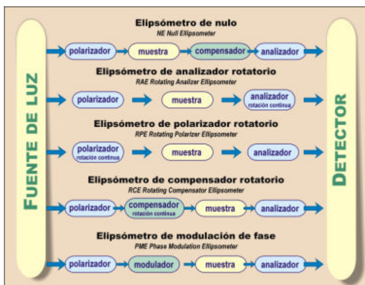
Figura 4. Dispositivos elipsométricos más comúnmente utilizados.
