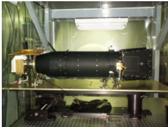
Figura 12. Alineamiento e integración de la cámara óptica OMC del satélite Integral de la ESA. (Sala limpia del LINES-INTA).
