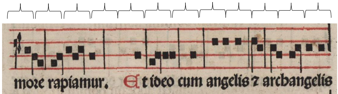
Fig. 122. Detalle del tercer tetragrama localizado en el folio 1 recto del cuadernillo musical del Manuale Burgense, impreso en Burgos por Fadrique Alemán de Basilea en 1501, donde se señala la utilización de los tipos para la impresión del tetragrama. Digitalización facilitada por la Real Academia de la Historia.
