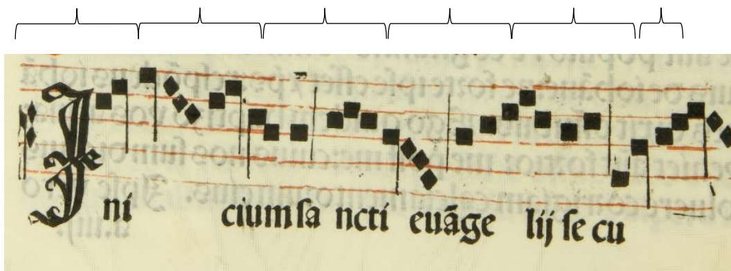
Fig. 221. Detalle de la impresión In matutinis domini en pentagramas en el folio III vuelto del Missale Valentinum, impreso en Valencia por Jorge Costilla c. 1520, donde se señalan los tacos xilográficos individuales que forman el pentagrama. Digitalización facilitada por la Biblioteca Capitulada de la Catedral de Valencia.
