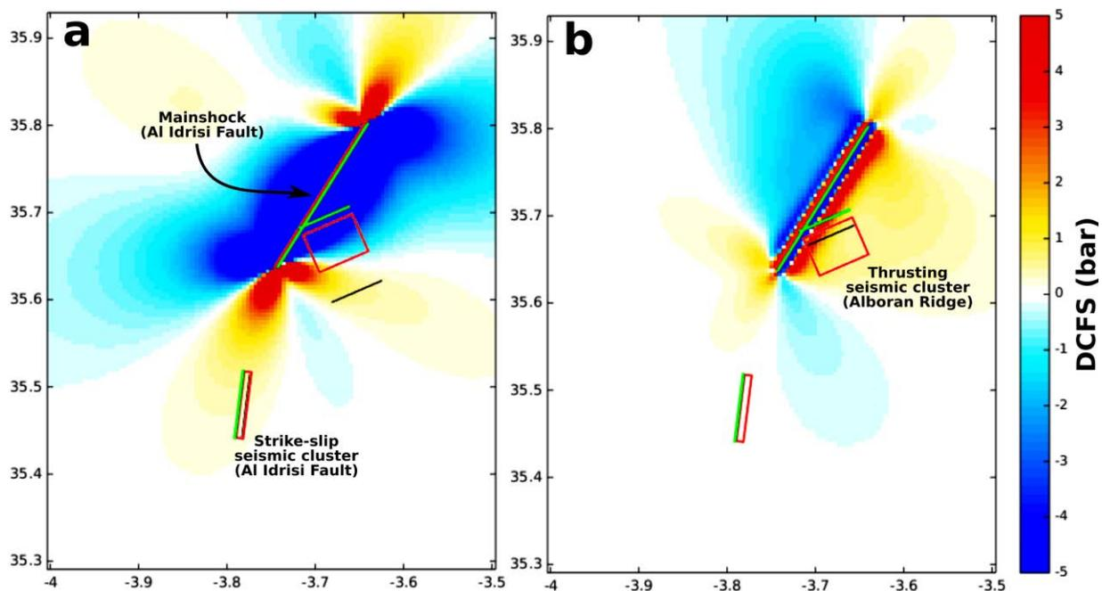
FIGURA 3. a) Variación de esfuerzos estáticos de Coulomb de la agrupación del evento principal sobre planos de desgarre sinistral con componente normal ( $9^\circ$  de cabeceo), N14-80. b) Variación de esfuerzos estáticos de Coulomb de la agrupación del evento principal sobre planos N66-26 de falla inversa.
