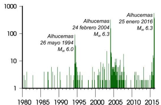
FIGURA 1. Evolución de la sismicidad con el tiempo en la zona. Número de eventos con  $M \geq 2$  por mes.
