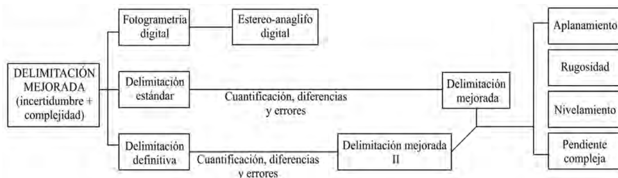
Figura 3.—Metodología propuesta para minimizar los errores al delimitar Unidades Territoriales Integradas (UTI) de naturaleza fisiográfica, utilizando los datos y procedimientos estándar proporcionados por los organismos oficiales y técnicos.
