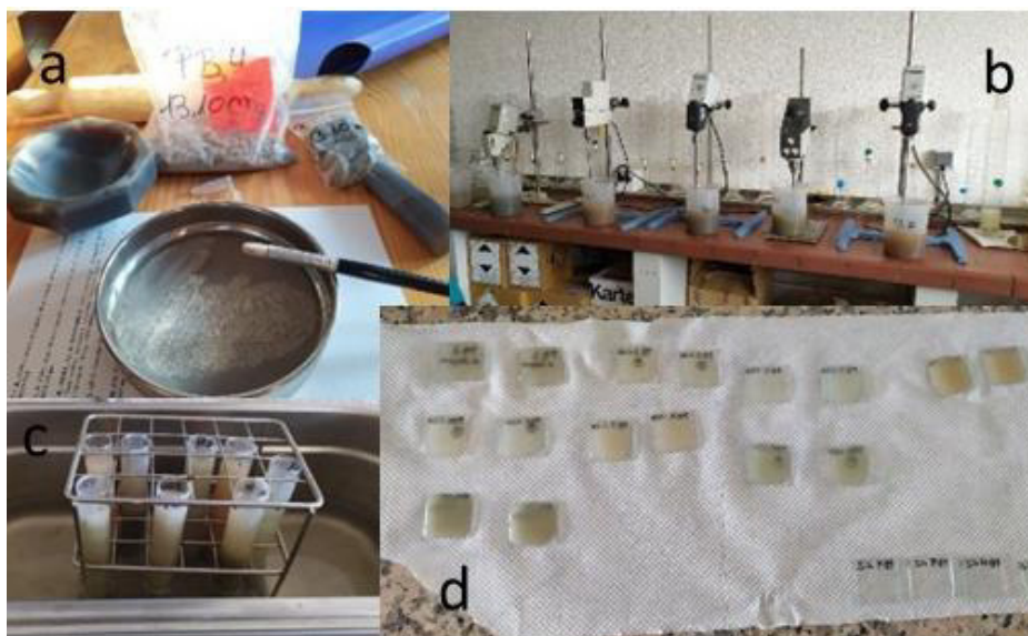
Figura 3.2. Preparación de las muestras. a) metodología para polvo con mortero de ágata. b) preparación de las suspensiones con agitadores. c) preparación de fracción < 2\mu . d) agregados orientados
