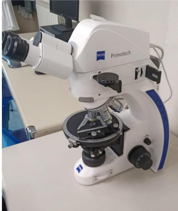
FIGURA 4 MICROSCOPIO PETROGRÁFICO ZEISS MODELO PRIMOTECH. UNIDAD DE TÉCNICAS GEOLÓGICAS. CAI DE CIENCIAS DE LA TIERRA Y ARQUEOMETRÍA. UCM.
