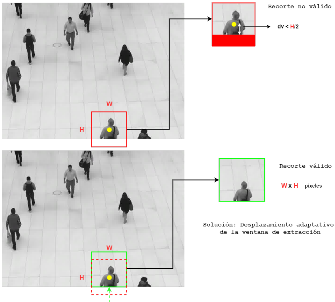
Figura 6.9: Ejemplo de un desplazamiento adaptativo de la ventana de extracción
