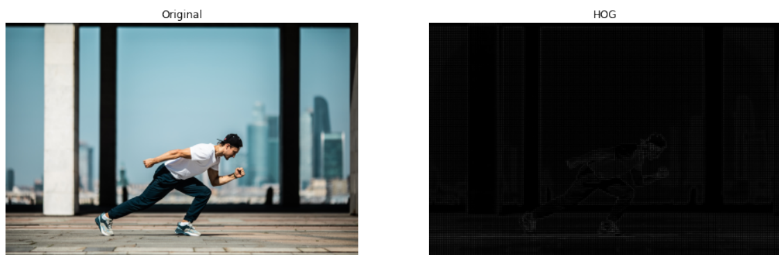
Figura 2.1: Aplicación de HOG a una imagen(6)
