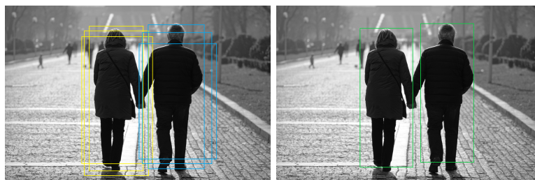
Figura 6.3: Ejemplo de aplicación de NMS a una imagen (6)
