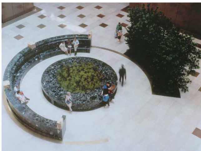
Equitable Center, NY, 1986. Equipamiento del atrio en mármol griego verde larisa, suelo en granito y mármol.
