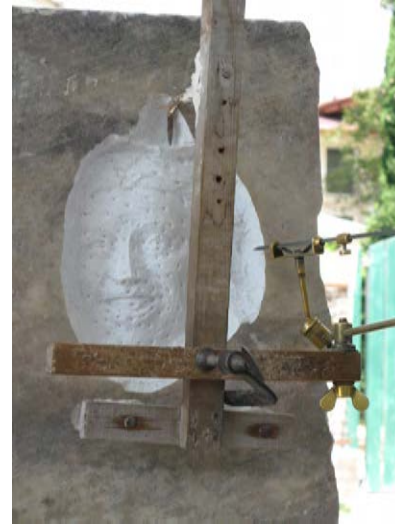
Copia en un bloque de mármol utilizando el sistema de puntos.
