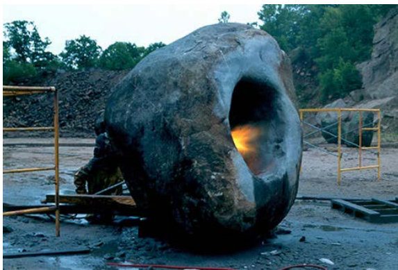
Flameado de la piedra para realizar la abertura. Cantera de Barre , Vermont, EEUU.
