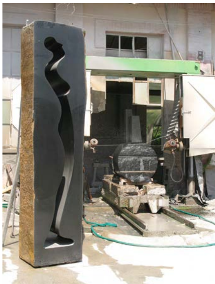
Puente de corte con hilo de diamante.
