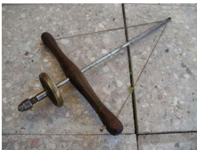
Trepano de arco s.XX, utilizado en joyería para metales blandos.
