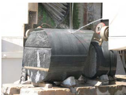
Corte con hilo de diamante sobre un bloque de basalto.
