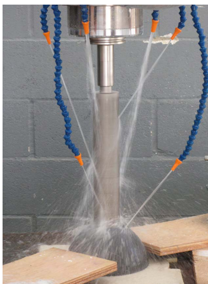
Detalle de la corona perforando una de las piezas.
