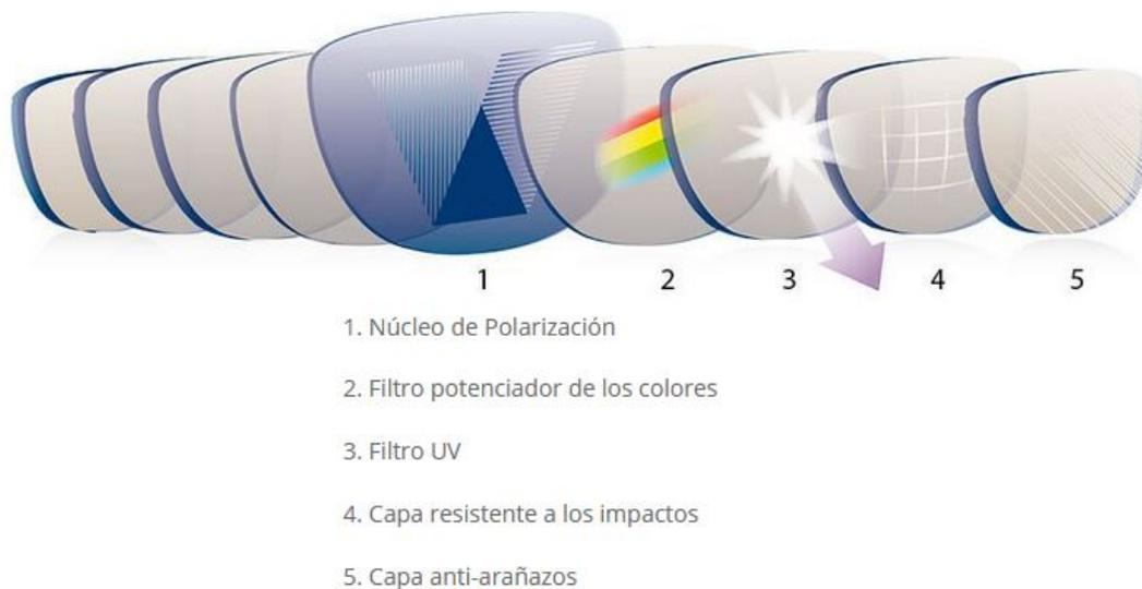
Figura 4.44: Ejemplo de lentes polarizadas
