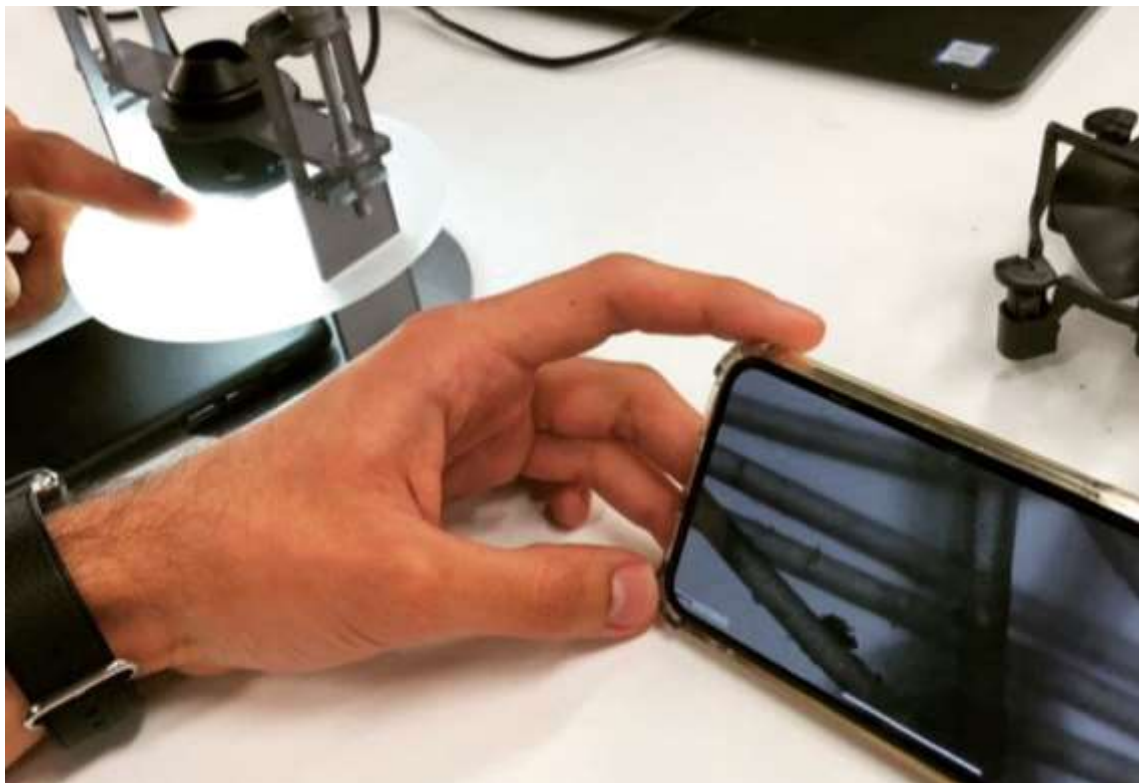
Figura 56 y 57. Nota. Adaptado de Microscopio de alta definición inalámbrico , diseñado por el grupo de investigación en OCsH para la escolaridad, fotografía, 2019.
