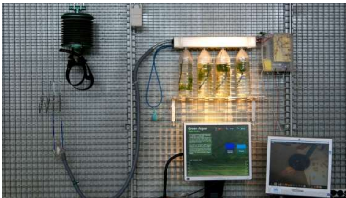
Figura 39. Nota. Adaptado de prototipo de biorreactor para el cultivo de algas verdes desarrollado durante interactivos?´10 , fotografía, 2010.
