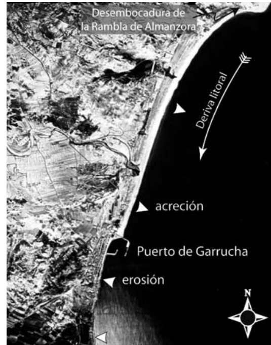
Fig. 2. Impacto que ha supuesto la construcción del puerto de Garrucha (Almería) en la dinámica litoral y en la distribución de zonas de acreción y erosión. La foto corresponde al vuelo de 1957 (vuelo americano). Se observa sedimentación y avance de la línea de costa aguas arriba del puerto, mientras que aguas abajo la falta de los sedimentos que han quedado retenidos previamente, provoca la erosión y retroceso.
