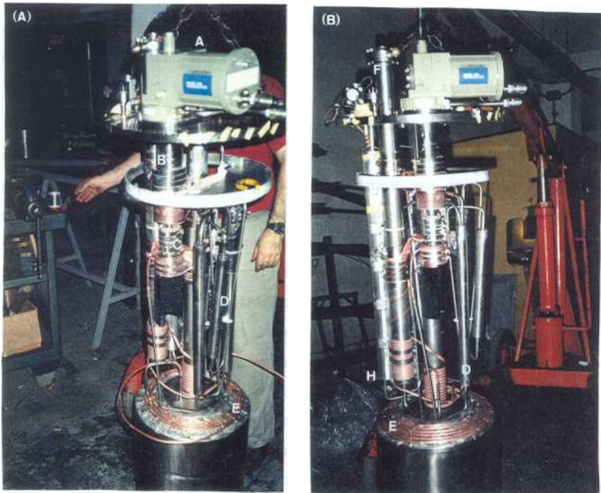
FIGURA 2.8: Vista del interior del sistema de licuefacción de helio líquido desde dos ángulos diferentes (a) y (b). (A) cabeza fría, (B y C) cilindros del circuito G-M, (D) intercambiadores de calor en contraflujo, (E) intercambiador de calor con el dewar de almacenamiento (F) entrada de gas del exterior, (H) etapa de estrangulación J-T.
