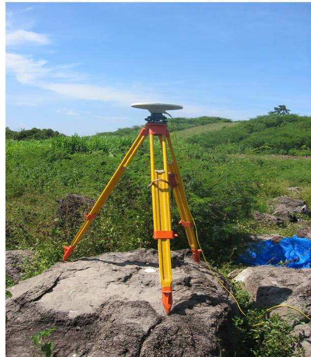
FIGURA 2. Imagen de estacionamiento de antena GPS Trimble ZEPHYR Geodetic con trípode. Estación perteneciente a la ZFESNET situado sobre roca estable.
