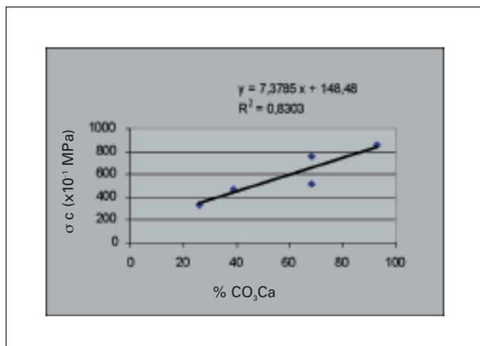
Fig. 6. Relación entre el contenido en CO<sub>3</sub>Ca y la resistencia a compresión uniaxial en las dolomías del Lías inferior
