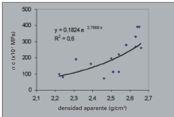
Fig. 4. Relación entre la resistencia a compresión simple y la densidad aparente en los materiales del Rethiense
