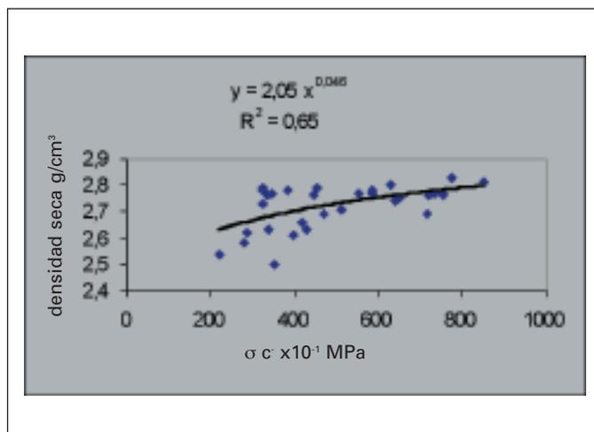
Fig. 7. Relación entre la densidad seca y resistencia a compresión simple en los materiales carbonatados del Lías
