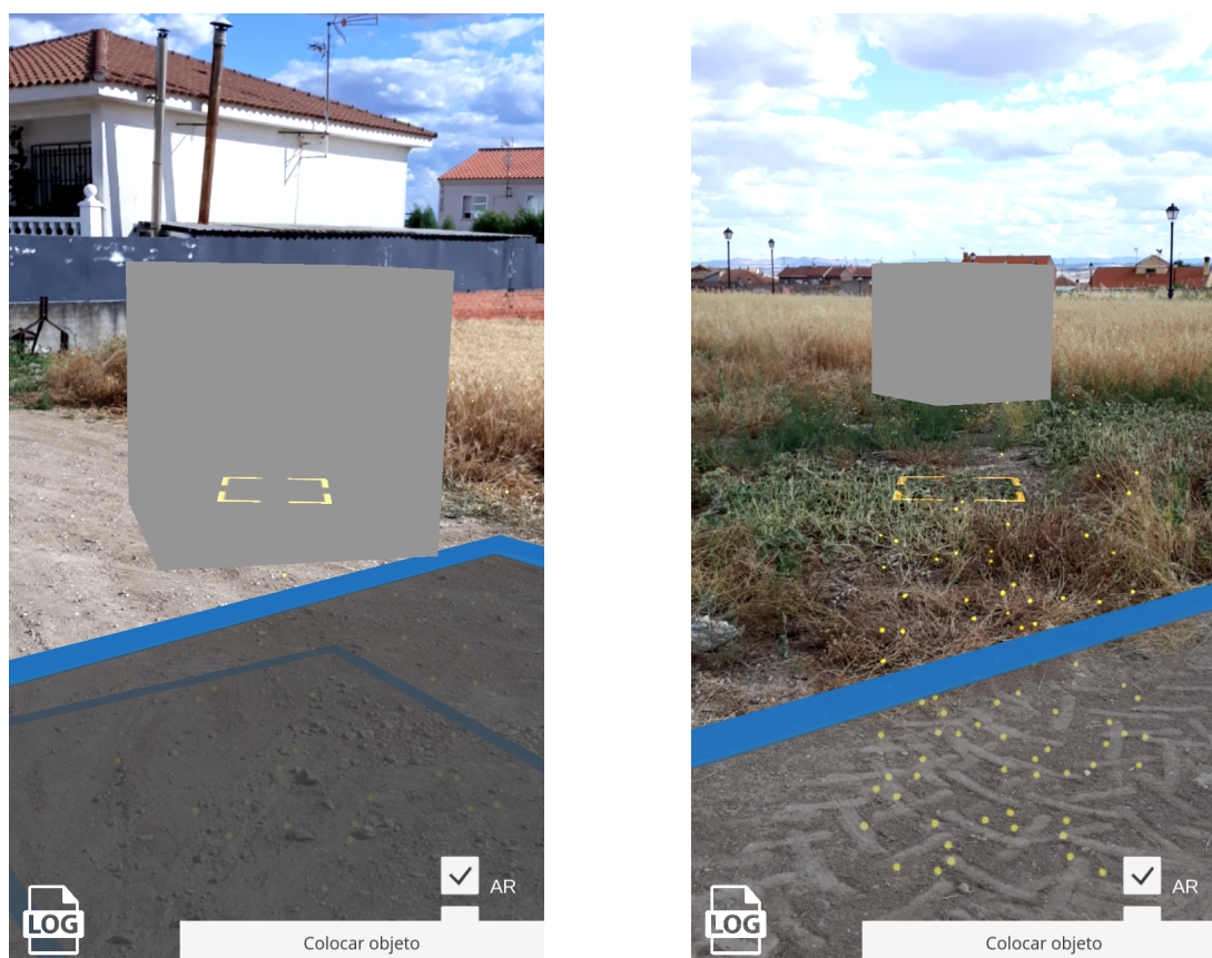
Figura 4.5: Pruebas de la transformación de coordenadas en exteriores.
