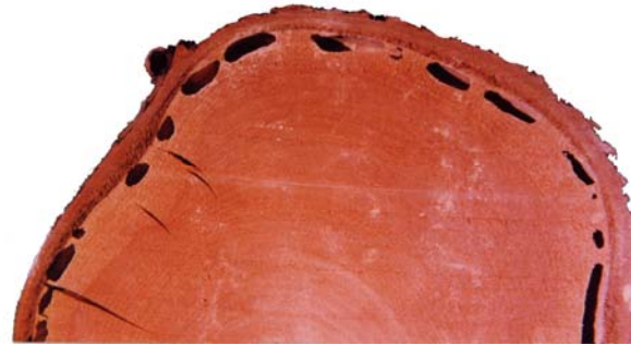
fig. 23 Ataque de la madera por insectos xilófagos.
