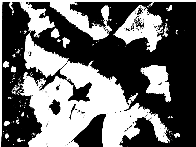
b.- Cobre OF, deformado 30% con 5 min. a 255°C, x 40000
