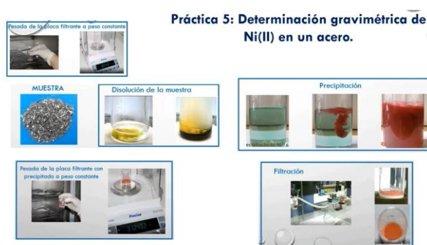
Figura 4. Ejemplo del material didáctico preparado para la Práctica 5: determinación gravimétrica de Ni(II) en un acero ( https://www.youtube.com/watch?v=Xzj0OzGk10Q )
