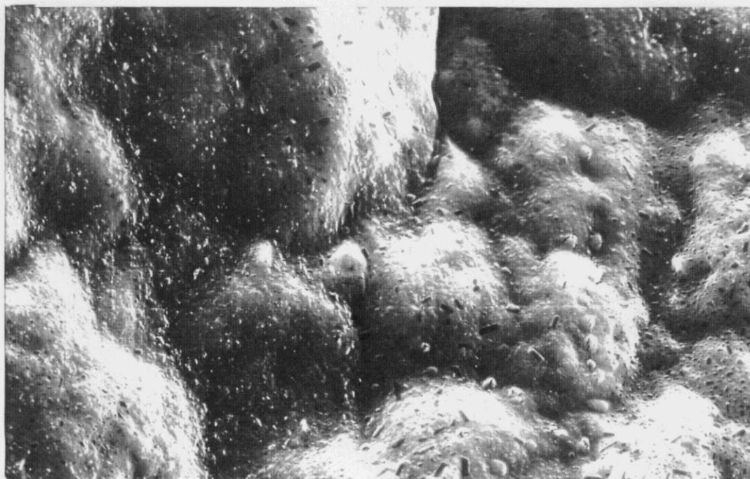
Figura IV.10. Micrografías electrónica de barrido de la cara de crecimiento de las películas de PFu/CIO<sub>4</sub>: (a) D<sub>1,7</sub> (  $\frac{1 \mu\text{m}}{\quad}$  ), (b) D<sub>1,9</sub> (  $\frac{10 \mu\text{m}}{\quad}$  ).
