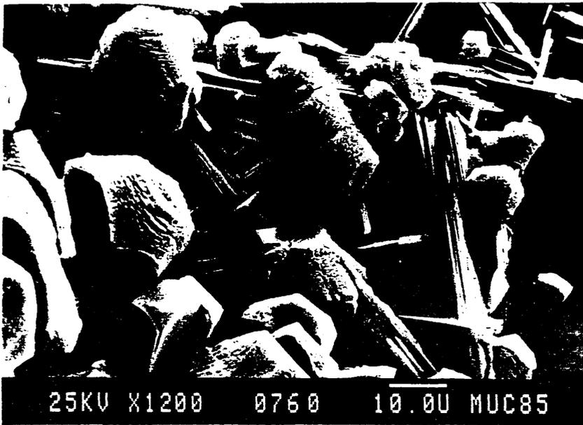
Fig. 7.33. Crecimientos epitáxicos de cristales de caras curvas, sobre agregados aciculares laminares (M.E.B.).
