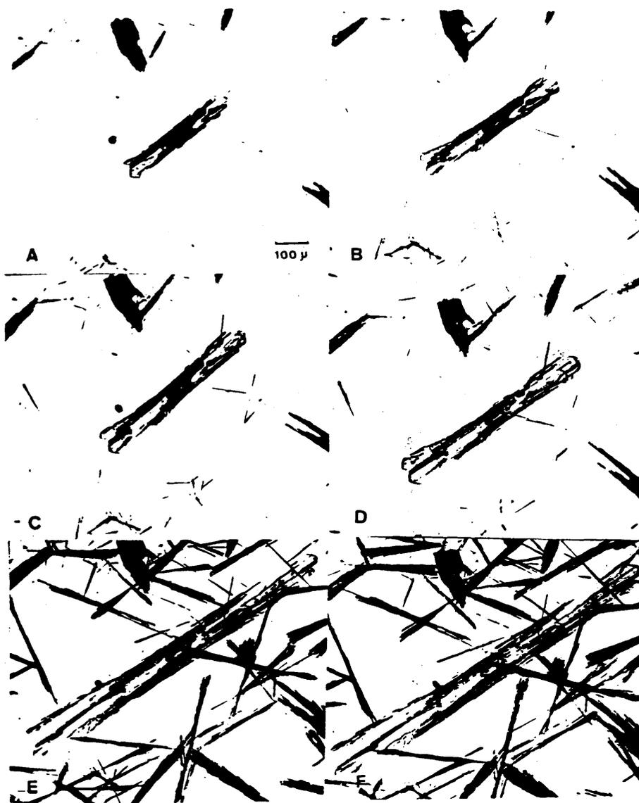
Fig. 6.20. Secuencia E. Diferentes estadios de crecimiento del agregado, a lo largo de los siguientes tiempos de experiencia: A = 0 ; B = 3 ; C = 4 ; D = 5 ; E = 10 y F = 11 días.
