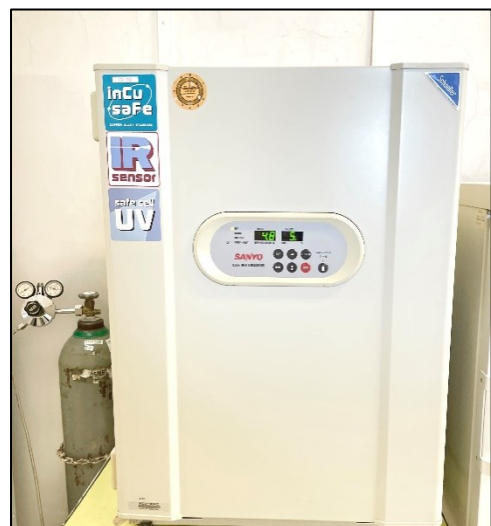
Obrázek 14 – inkubátor s atmosférou 5% CO 2
