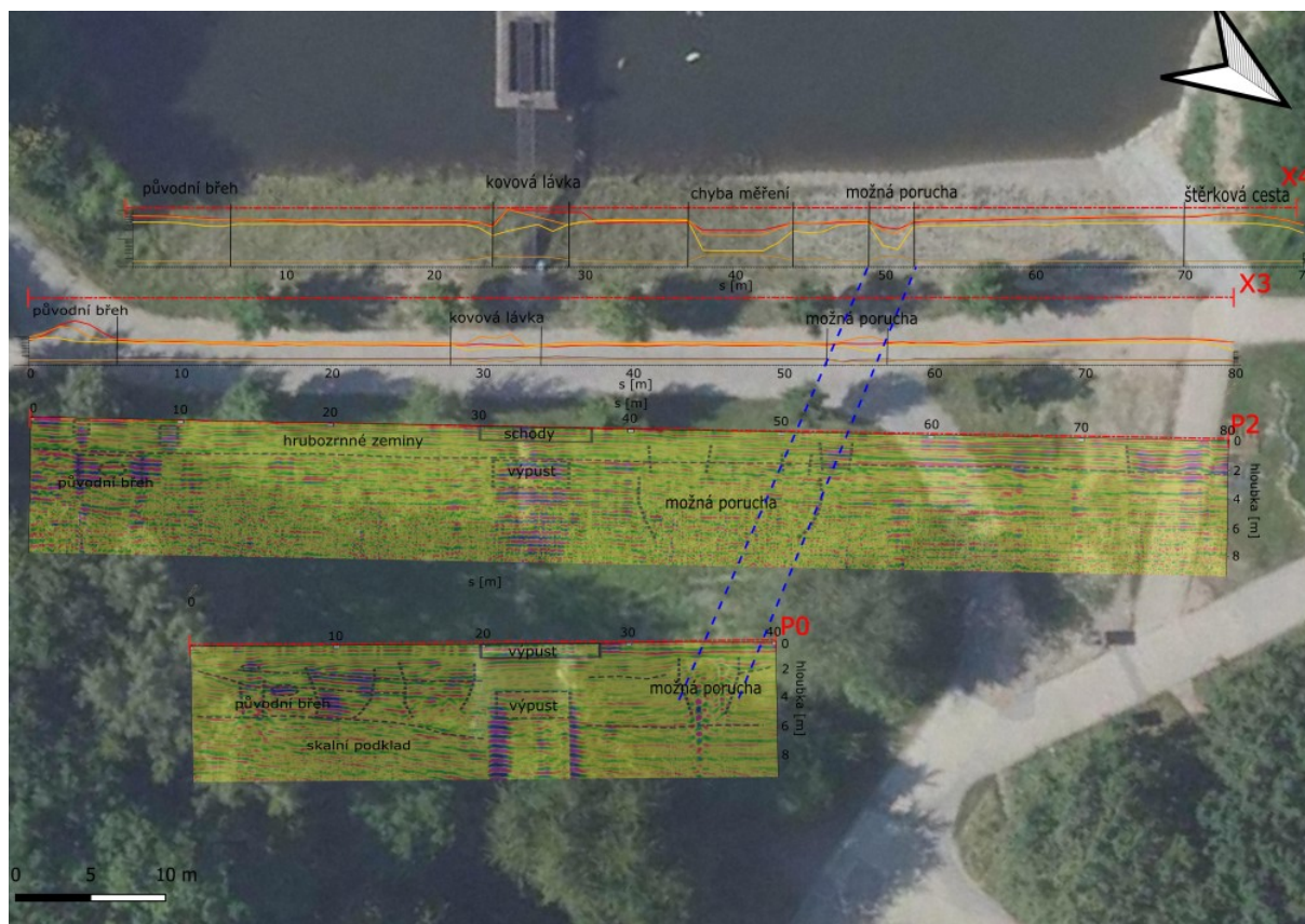
Obr. 41 Měřené profily metodami DEM a GPR, kde se vyskytují anomálie, která značí možná místa průsaku tělesem hráze.
