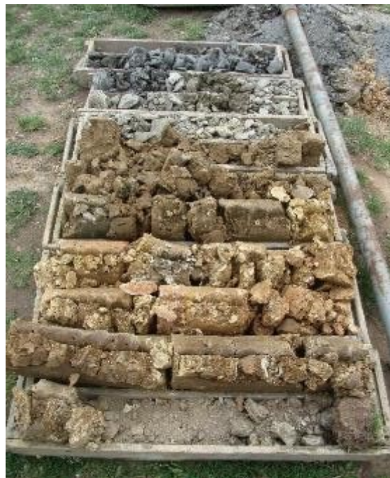
Obr. 21 Vrtné jádro z průzkumného vrtu MV1
