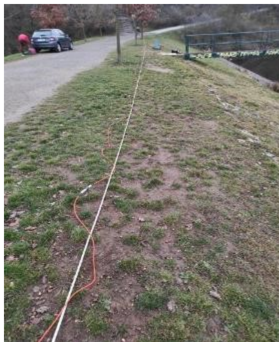
Obr. 27: Umístění elektrod v rámci geofyzikálního průzkumu na koruně hráze na lokalitě.
