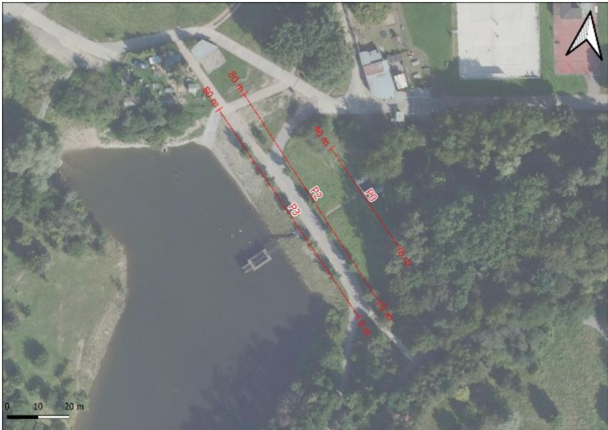
Obr. 28 Měřené profily prováděné metodou GPR.
