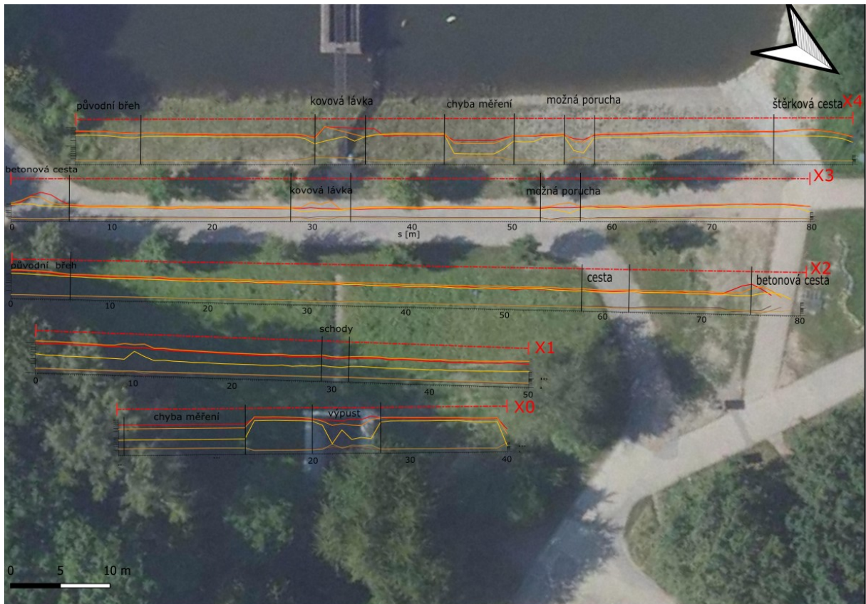
Obr. 38 Křivky zdánlivého měrného odporu měřené metodou DEMF.
