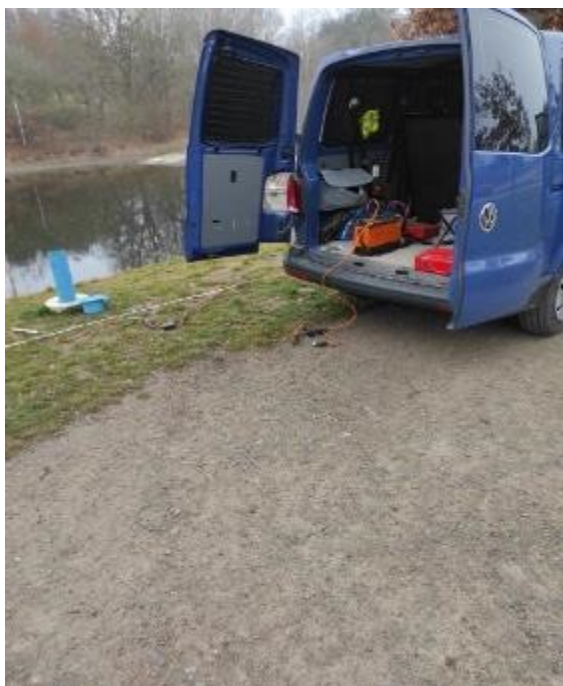
Obr. 26: Měřicí přístroj Ares II při terénním geofyzikálním měření.
