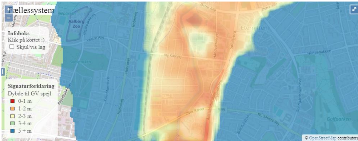
Figur 5.29: Simulering af dybden til grundvandsspejlet fra terræn for modelscenariet med det nuværende system og klimascenariet "nær-fremtid". Der er meget lille forskel på den nuværende situation og "nær-fremtid", hvorfor den nuværende situation ikke vises grafisk.
