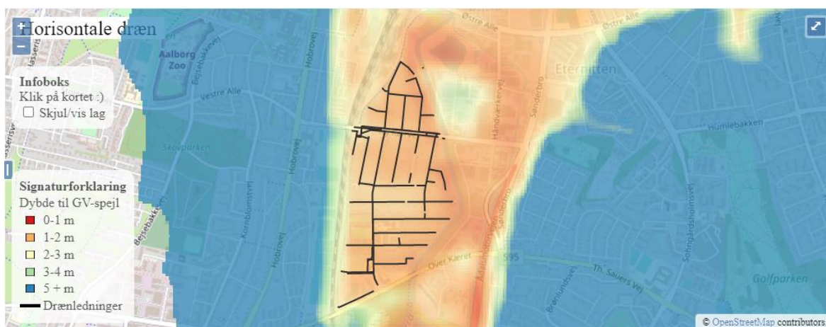
Figur 5.37: Simulering af dybden til grundvandsspejlet fra terræn for modelscenariet med horisontale drænelinger og klimascenariet "nær-fremtid". De horisontale drænelinger er lagt i samme tracé og dybde som det nuværende kloaksystem.
