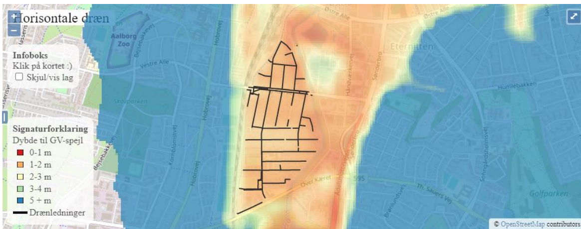
Figur 5.38: Simulering af dybden til grundvandsspejlet fra terræn for modelscenariet med horisontale drænledninger og klimascenariet "fjern-fremtid".
