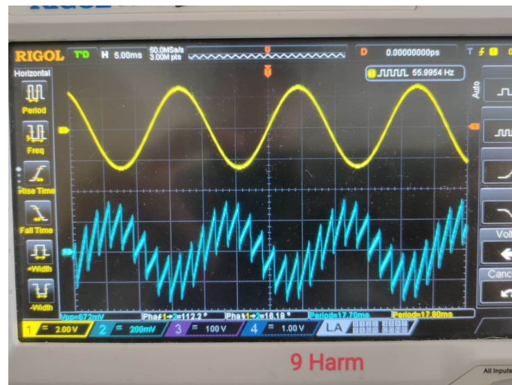
Figura 6.6: Adição de dente-de-serra de amplitude constante a senoide de baixa frequência
