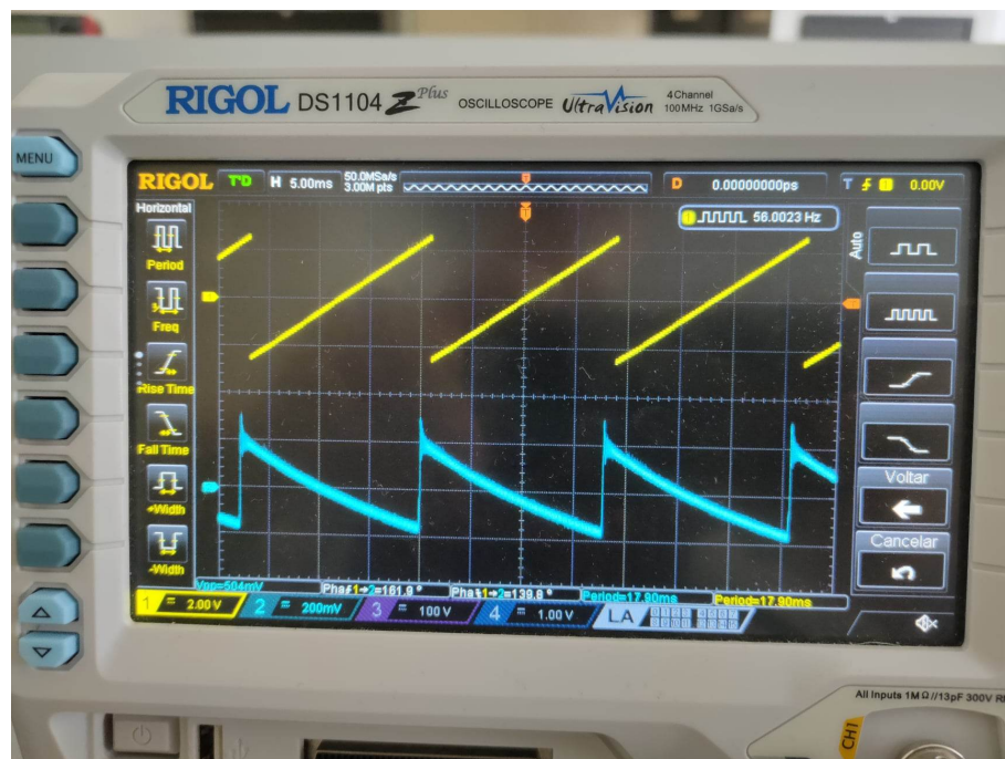
Figura A.4: Verificação de onda dente-de-serra (traçado inferior)
