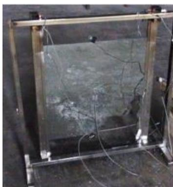
Figura 3.4 – Rotura de fachada de vidro exposta à condições de incêndio [52].
