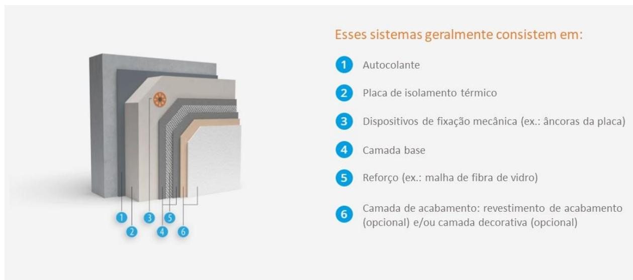
Figura 3.5 – Representação esquemática de uma fachada em ETICS [54]
