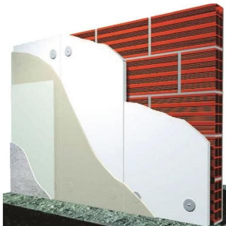
Figura 2.6 - Modelo de fachada ETICS com isolamento de EPS [37]
