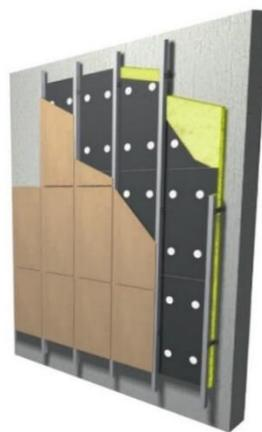
Figura 2.5 - Modelo de fachada ventilada com isolamento de lã de rocha [34]
