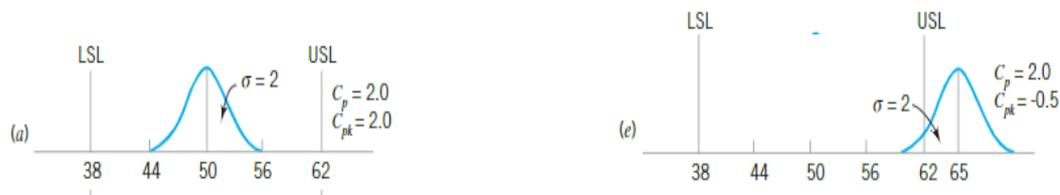
Figura 4: Exemplo da relação entre Cp e Cpk (Fonte: Montgomery 2013)
