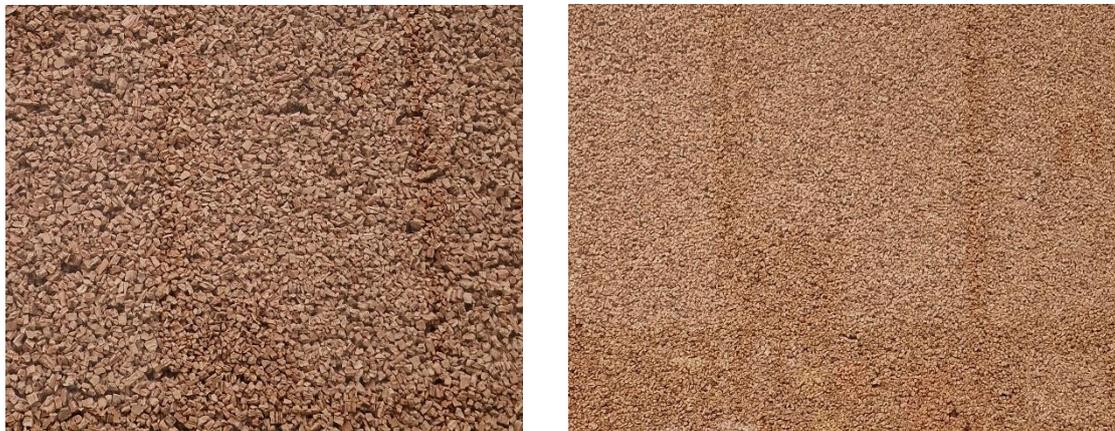
Figura 8: Granulado RCT, à esquerda, e granulado RN, à direita
