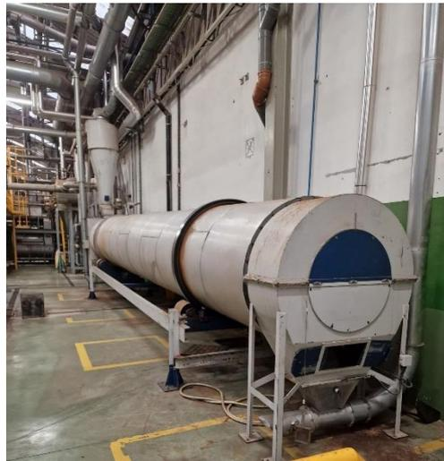
Figura 32: Secador de granulado da DeSousa
