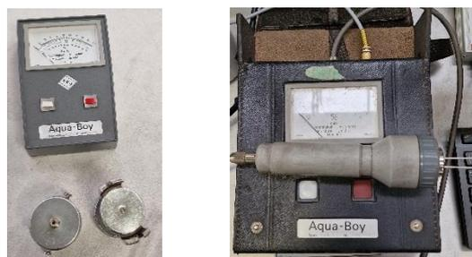
Figura 44: Higrómetro da DeSousa com adaptação para medição de granulado, à esquerda, e medição de rolhas, à direita
