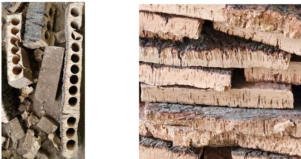
Figura 7: Aparas de cortiça, à esquerda, e cortiça de baixa qualidade, à direita
