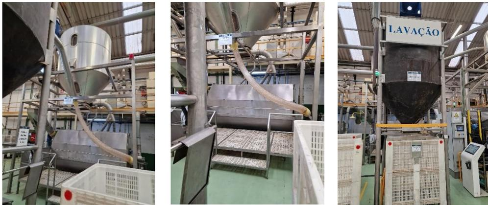
Figura 36: Silo de alimentação, Tambor de lavação e Silo de descarga da DeSousa
