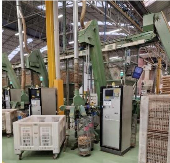
Figura 38: Máquina de escolha automática da DeSousa
