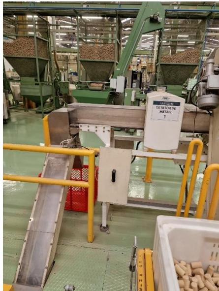
Figura 39: Máquina de deteção de metais da DeSousa
