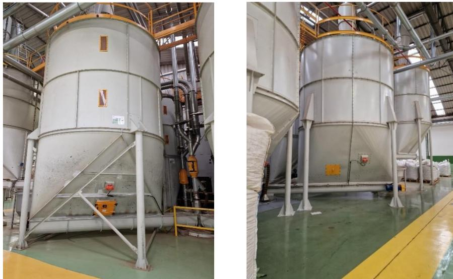
Figura 33: Silo de estabilização e silo de abastecimento de granulado da DeSousa
