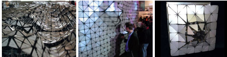
Fig.18.Aegis Hyposurface, conceito de Mark Goulthorpe da dECOi Architects O projecto foi desenvolvido para o concurso de uma instalação interactiva para o foyer do Birmingham Hippodrome Theatre. A peça é uma superfície metálica facetada que tem o potencial de se deformar em resposta a estímulos electrónicos captados, como movimento, som, luz, etc., vindos do ambiente à volta.
