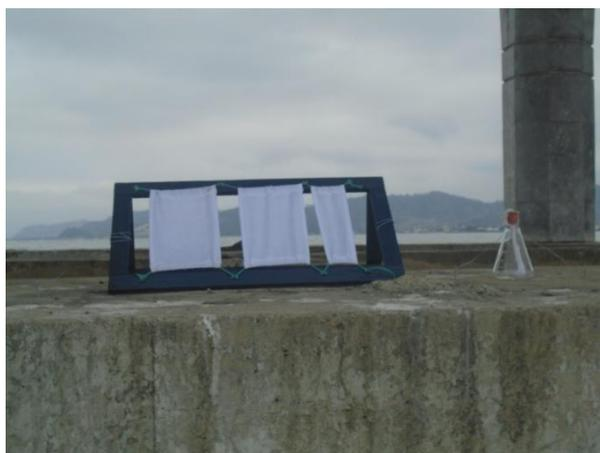
*Fig.2. Ejemplo de uno de los sitios de exposición colocados en una de las vigas de enlaces del puente.*
