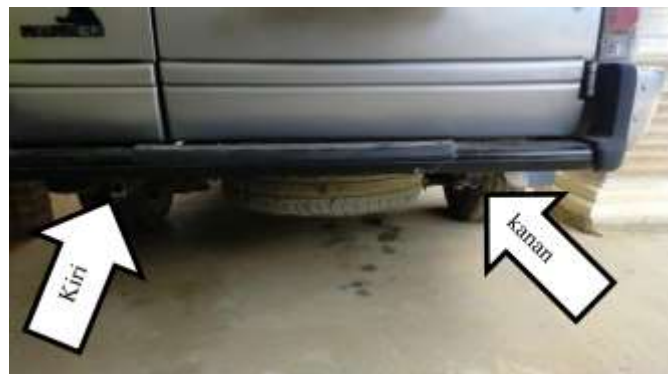
Gambar 5. Posisi penempatan sensor pada mobil MPV
