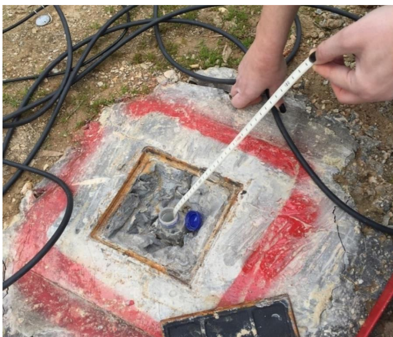
Εικόνα 1.14. Μέτρηση της στάθμης του υδροφόρου ορίζοντα στη γεώτρηση Γ8.
