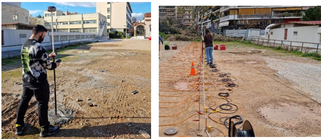
Εικόνα 3.4. Στιγμιότυπα από την τοπογραφική αποτύπωση των θέσεων των γεωτρήσεων (αριστερά) και ηλεκτροδίων (δεξιά).
