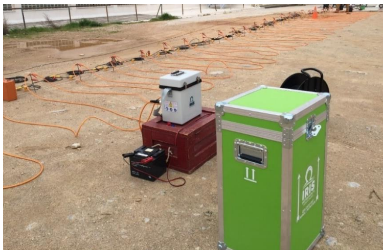
Εικόνα 3.1. Παρουσίαση του εξοπλισμού που χρησιμοποιήθηκε για την εκτέλεση της μεθόδου ERT.
