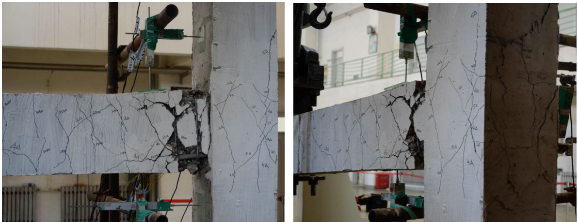
Fig. 7. Damage in BJD-3.
