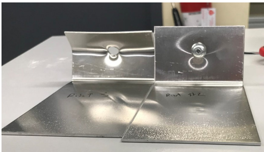
Figure 34 : Bris typique des joints rivetés de la série 3
