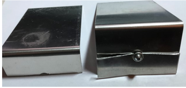
Figure 39 : Bris typique en fatigue des joints rivetés de la série 3
