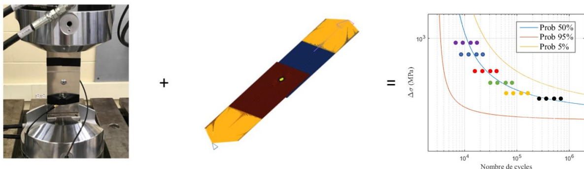
Figure 49 : Génération des courbes S(N) pour les joints rivetés
