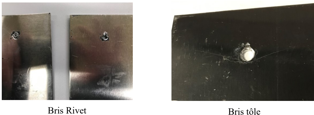
Figure 38 : Bris typique en fatigue des joints rivetés de la série 2
