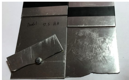
Figure 37 : Bris typique en fatigue des joints rivetés de la série 1
