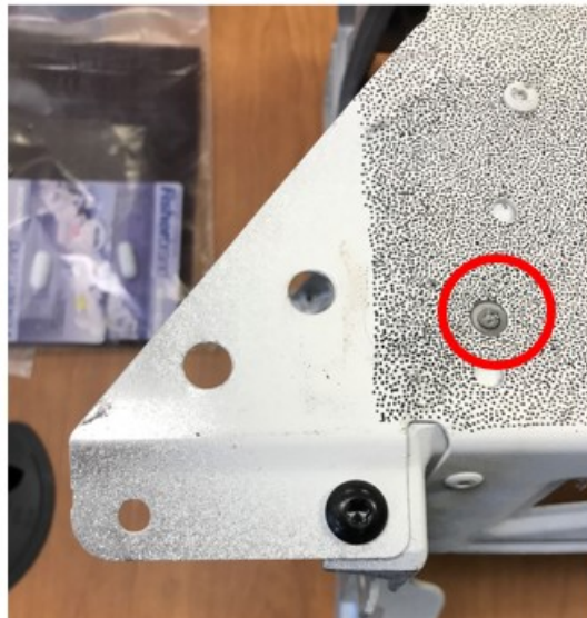
Figure 98 : Bris typique du module E lors des essais expérimentaux
