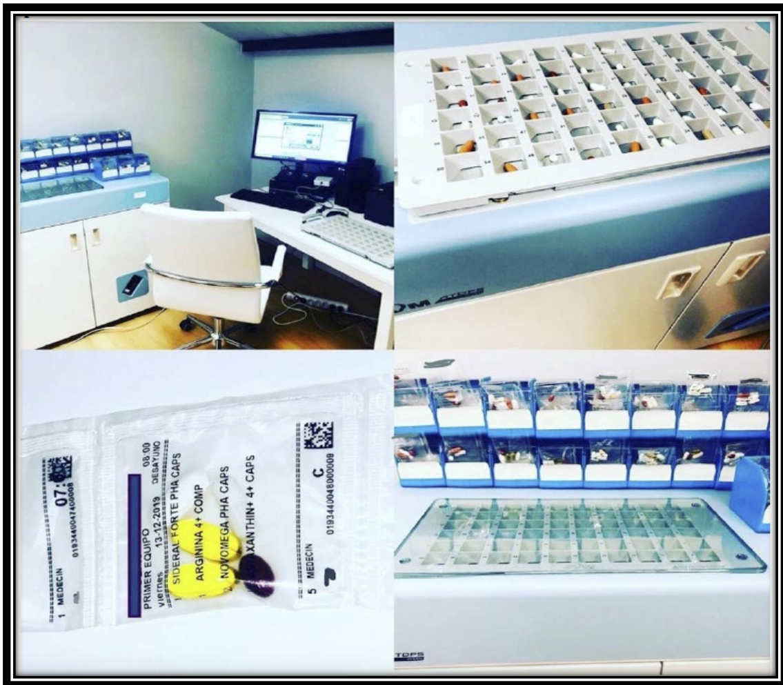
Figura 7. Máquina emblistadora TIMEDI JV-DEN.
