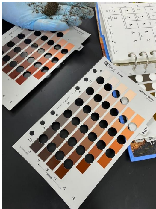
Figura 5. Obtención de color del suelo con ayuda del manual de color Munsell.
