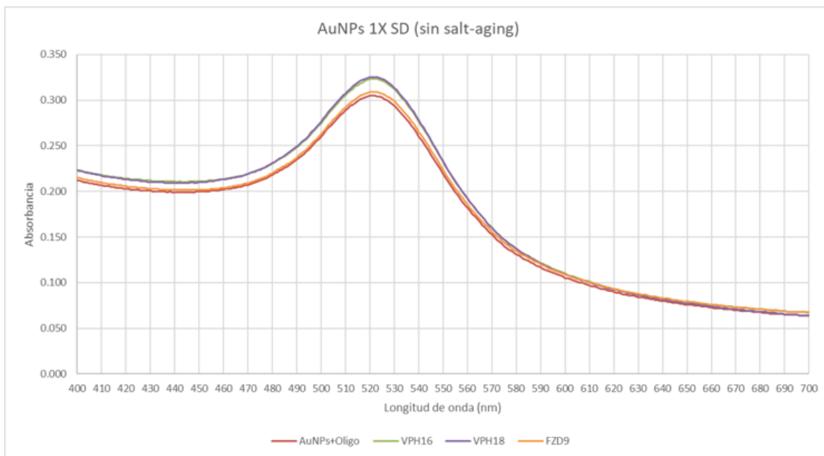
Figura 11. Ejemplo de respuesta plasmónica de nanopartícula funcionalizada y con muestras de ADN.
