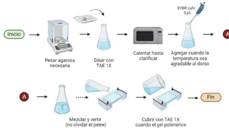
Figura 2. Diagrama de construcción del gel de agarosa para electroforesis [18].
