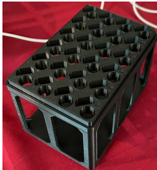
Figura 26. Impresión 3D de partes para Opentrons.
