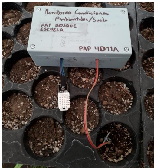
Figura 40. Carcasa del prototipo en prueba de funcionamiento.
