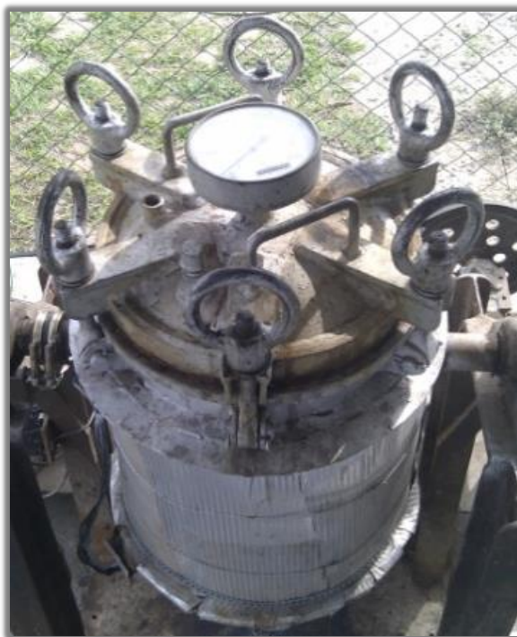
Figura 4.2: Reactor de hidrólisis a escala miniplanta.
