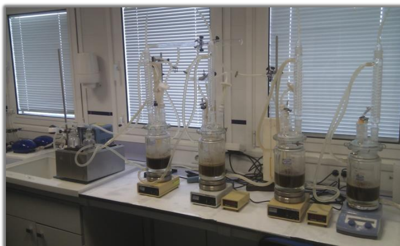
Figura 4.5: Instalación de 4 biorreactores de bancada conectados en serie.
