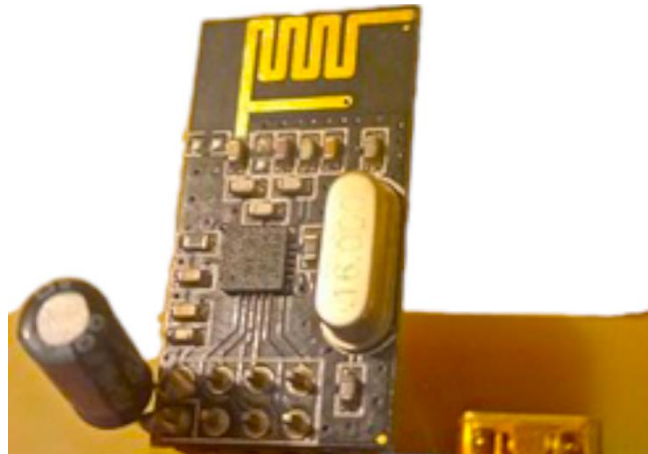
Figura 3.10: Colocación del capacitor en la entrada de voltaje del módulo nRF24L01
