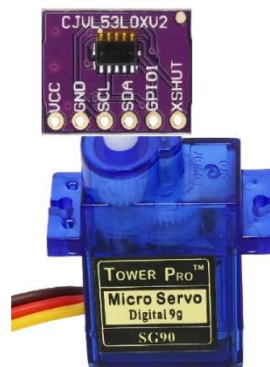
Figura 3.7: Sensor LiDAR colocado sobre el servomotor
