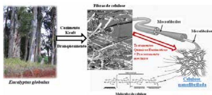
Figura 1: Ilustração esquemática da preparação de celulose nanofibrilada. Adaptado de Alves et al. [3] com a permissão de Elsevier.
