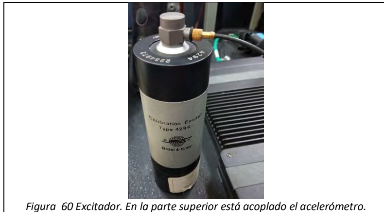
Figura 60 Excitador. En la parte superior está acoplado el acelerómetro.
