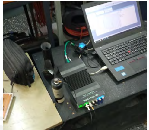
Figura 57 Equipo de medición. Excitador con acelerómetro conectado, equipo Brüel & Kjær y software Pulse Labshop ejecutándose en computadora.
