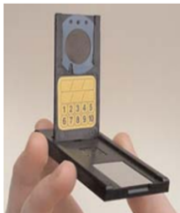
Figura 5.3. Detector en modo abierto o desnudo de la firma Kodalpha [102].
