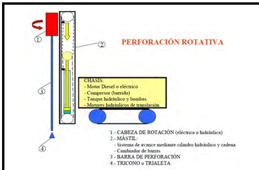
Figura 1. Componentes de un sistema de perforación a rotación
