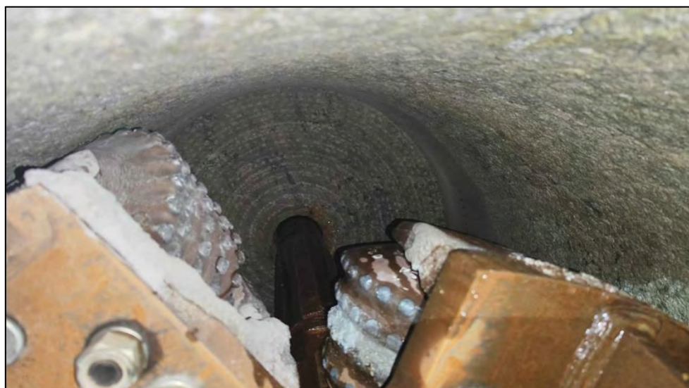
Figura 33. Sistema de corte de escariador
