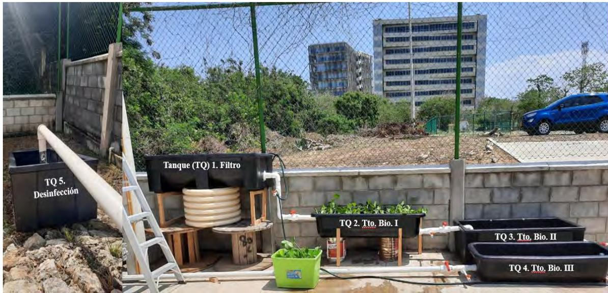
**Figura 3.** Bioprototipo instalado en el interior de la PTAR "Nuevos terrenos" de la Fundación Universidad del Norte.
