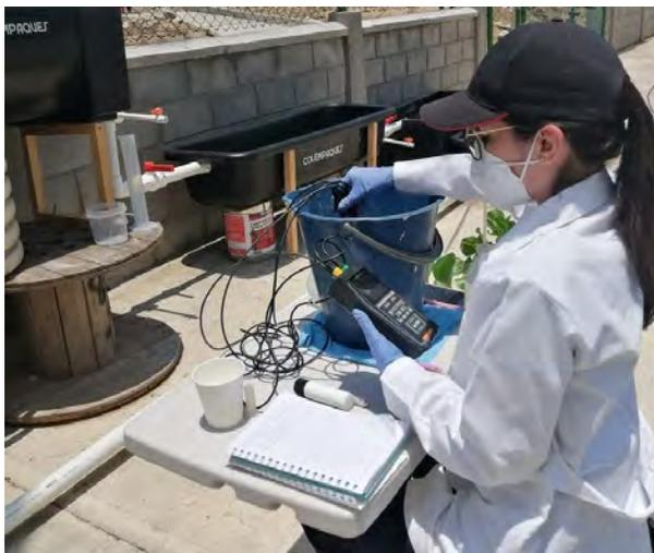
**Figura 1.** Medición *in situ* de parámetros fisicoquímicos del ARD: temperatura, pH, conductividad eléctrica y oxígeno disuelto.
