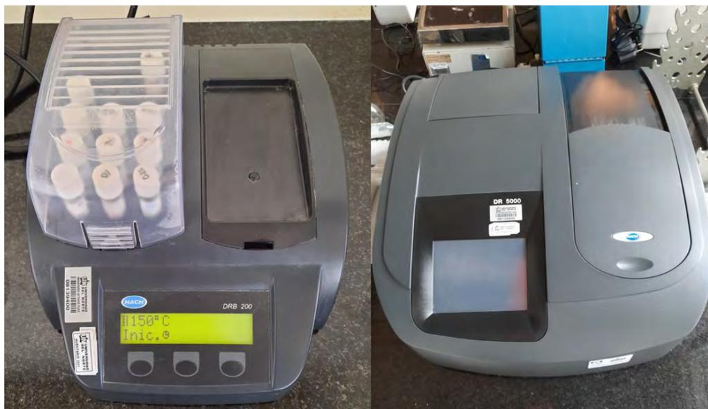
**Figura 5.** Procesamiento y lectura de DQO. Izquierda: termoreactos, Derecha: espectrofotómetro.
