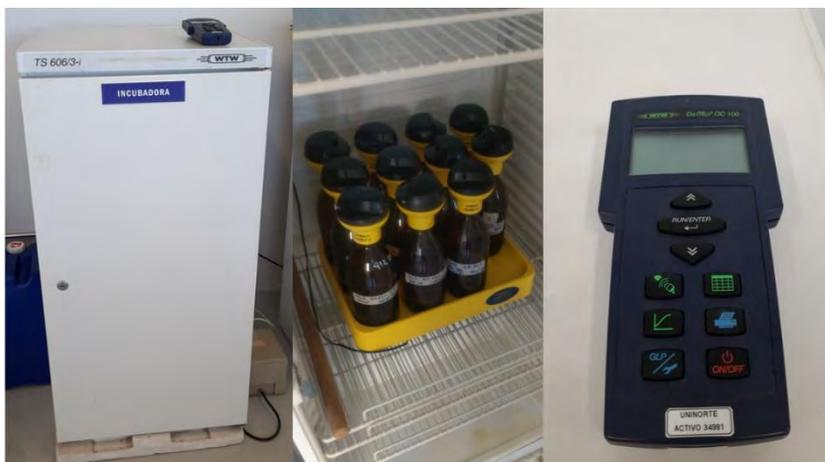
**Figura 3.** Medición en laboratorio de  $DBO_5$ . Izquierda: Incubadora, Medio: Muestras en incubación por 5 días a 20°C y, derecha: control Oxitop™.
