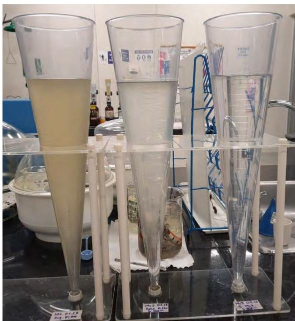
Figura 7. Medición de sólidos sedimentables en conos Imhoff.
