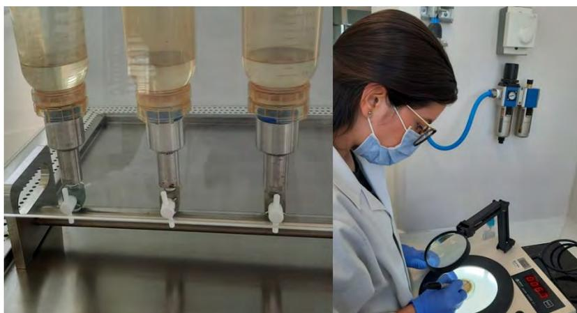
**Figura 10.** Procesamiento de muestras de ARD para recuento de coliformes totales y fecales, mediante el método de filtración por membrana. Izquierda: filtración por membrana de muestra de ARD, derecha: conteo de colonias de CT y CF.
