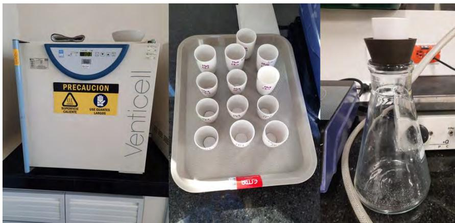
**Figura 6.** Medición de sólidos suspendidos totales por secado a 10-105°C. Izquierda: horno de secado a 103°C, medio: combinación crisoles Gooch con filtro, derecha: filtración de la muestra.
