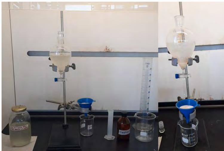
**Figura 8.** Procedimiento de extracción de grasas y aceites de una muestra de ARD.
